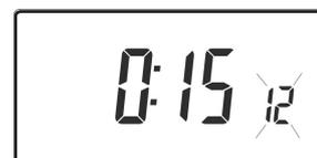
byla zohledněna tepelná charakteristika budovy. Pomocí tlačítek **Λ** a **V** zvolte požadovanou dobu předehřevu. V tabulce dole jsou uvedena typická nastavení. Jestliže teplota v budově nebude dosažena v požadovaném čase, tak zvyšujte nastavení každý den o 15 minut, dokud nedosáhnete požadované nastavení. Jestliže teplota v budově bude dosažena před požadovaným časem tak snižujte nastavení každý den o 15 minut, dokud nedosáhnete požadované nastavení.
