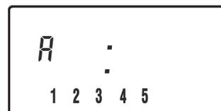
Použitím tlačítek + a – můžete přecházet mezi CZ jednotlivými dny týdne. Zrušení dne proveďte tisknutím tlačítka **V**, (například Den 2). Zvolení dne proveďte stisknutím tlačítka **Λ** (například den 7).
