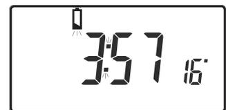
**ВАЖЛИВО:** Щоб увімкнути пристрій після заміни батарей, натисніть та звільніть кнопку **RESET**. Усі настройки дати, часу, програмування та тимчасового виходу за обмеження зберігаються впродовж строку служби пристрою
