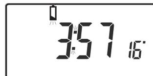
**UWAGA WAŻNE:** *Po wymianie baterii należy nacisnąć przycisk RESET w celu zrestartowania urządzenia. Wszystkie ustawienia dotyczące dnia, czasu, programowania oraz odnoszące się do ustawień ręcznych są zapamiętywane przez cały czas eksploatacji urządzenia.*
