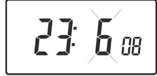
Ay içinde **GÜN (DATE)** ayarına gelmek için – ya da + komutlarını kullanınız, sonra doğru gün için **Λ** ya da **V** komutlarına basınız.
